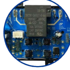
PCB üzerinde şeffaf silikon ile su geçirmezlik işlemi
